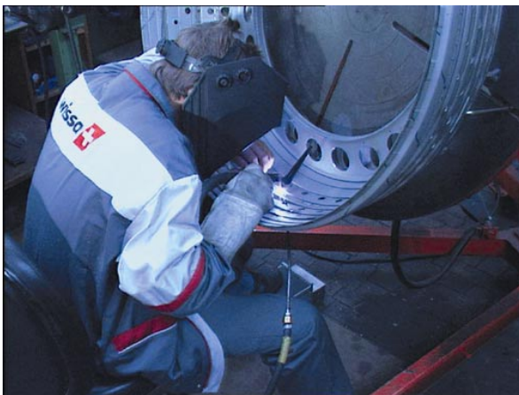
Bild 31 WIG-Schweißen bei der Reparatur von Triebwerksteilen
