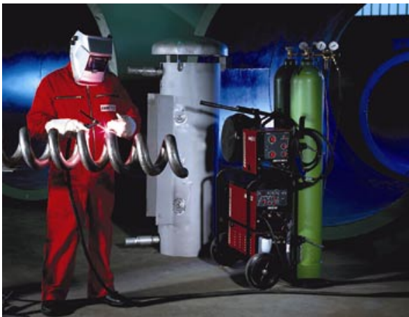
Bild 1 TRITON 260 DC, WIG-Verschweißen von Kühlschlangen
