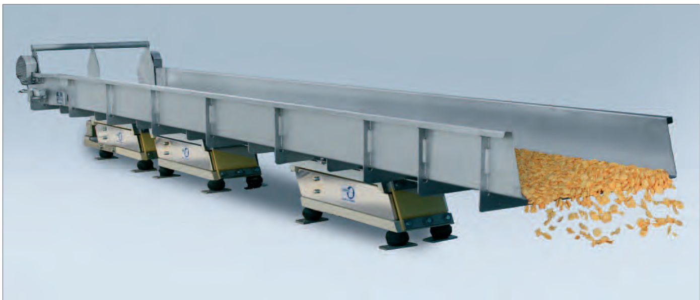
Bild 9 4,3 m lange und 750 mm breite Vibrationsförderrinne mit drei Antrieben ERF 62 und einer pneumatisch angetriebenen Austragsklappe zur Förderung von Kartoffelchips. Die Rinne ist Teilstück einer insgesamt 45 m langen Zuführstrecke.
