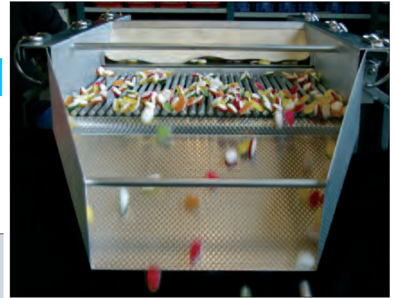
Bild 12 Siebrinne mit Antriebsblock ERF 42 für die Absiebung von Bruch
