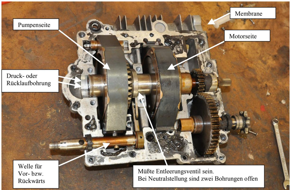
Getriebehälfte oben (Einbaulage 180° gedreht)
