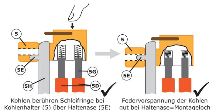
Kohlen berühren Schleifringe bei Kohlehalter (5) über Haltenase (5E) Federvorspannung der Kohlen gut bei Haltenase=Montageloch
