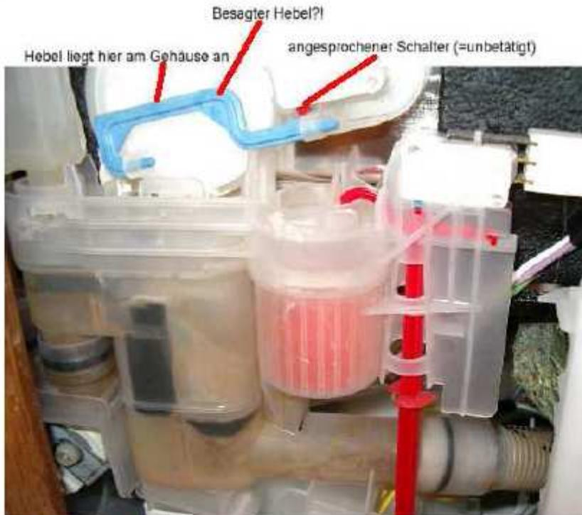
Ich nehme an, dass der blaue Hebel gemein ist. Der liegt im ausgeschalteten Zustand der Maschine an dem weißen runden Gehäuse an (da ist wahrscheinlich die erwähnte Membran drin). Dadurch, dass der Hebel dort anliegt ist der Microschalter nicht betätigt.
