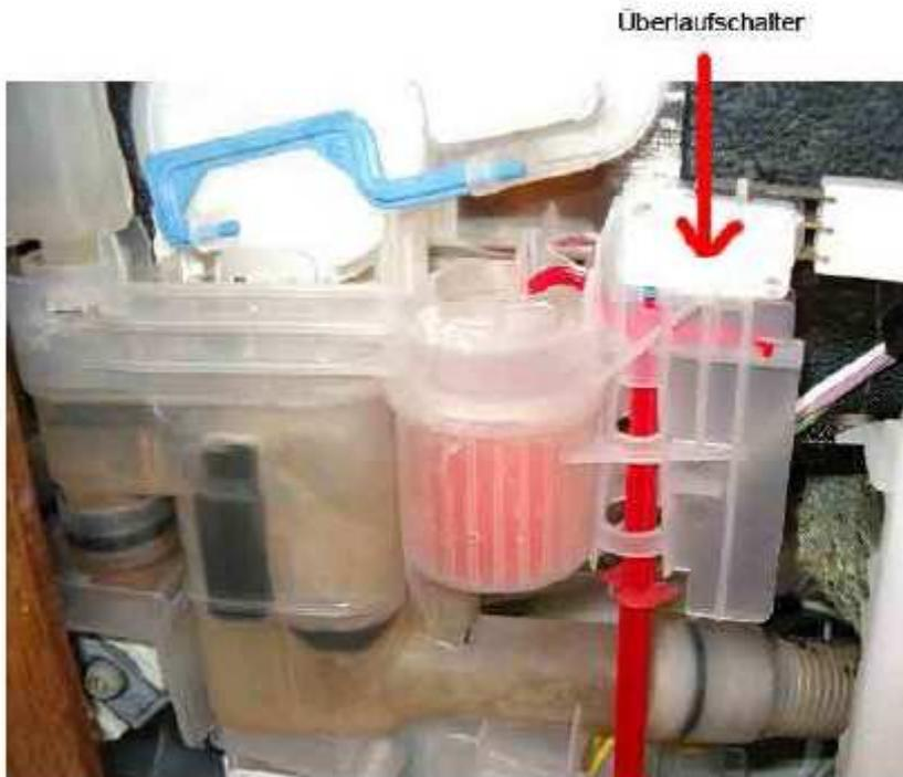
Dieser Schalter schaltet das Zulaufventil ab und die Ablaufpumpe (vorne links) ein. Soweit ich das anhand des Bildes erkennen kann ist der aber unbetätigt.
